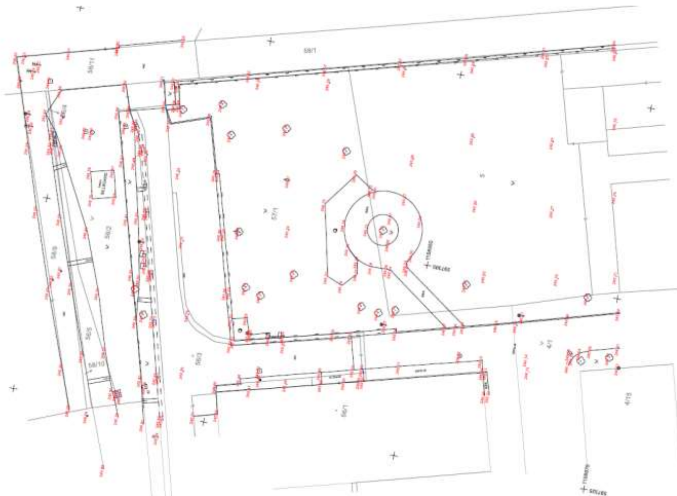
Obr.1: Ilustrativní obrázek účelové mapy. Účelová mapa geodetického zaměření je součástí průzkumných prací. Zdroj: GEODET-BRNO s.r.o.
